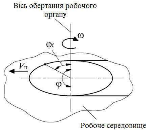
Рис. 2. Схема роботи торцевого робочого органа першого типу
