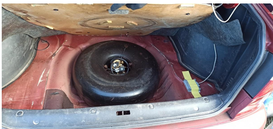
Рисунок 1 – Автомобіль Daewo Sens на якому проводилися дорожні експериментальні дослідження та місце кріплення трикоординатного датчика лінійних прискорень у багажнику
