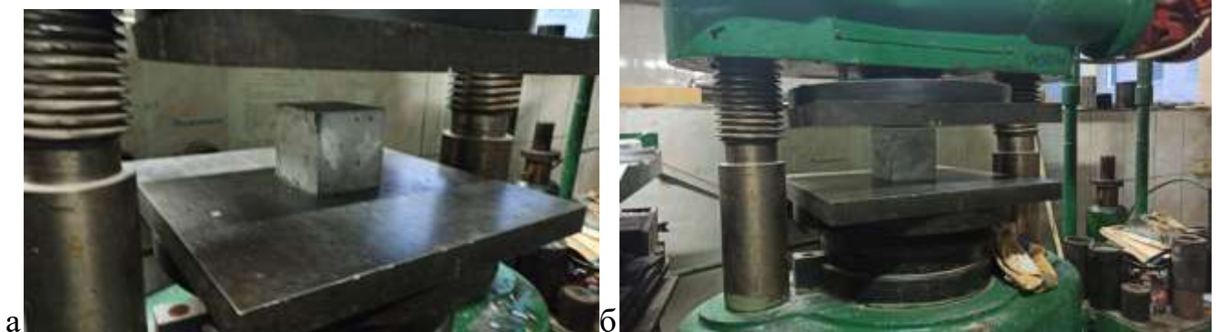
Рис. 3.42 – Підготовка випробування: а – встановлювання зразка на нижню опорну плиту преса; б – суміщення верхньої плити преса з верхньою гранню зразка
