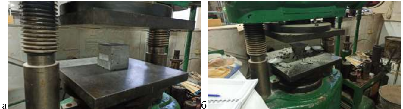
Рис. 3.40 – Випробування зразків бетону на лабораторному пресі: а – зразок до випробування; б – зразок після випробування
