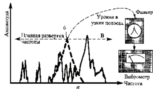
Рис. 3.50. Графические примеры контроля уровней вибрации с различной разрешающей способностью по частоте:
