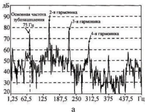
Рис. 3.52. Узкополосные спектры вибрации зубчатой передачи: а – спектр, содержащий серию гармоник частоты зубозацепления ведущей шестерни; б – расширенный узкополосный спектр в области частоты зубозацепления
