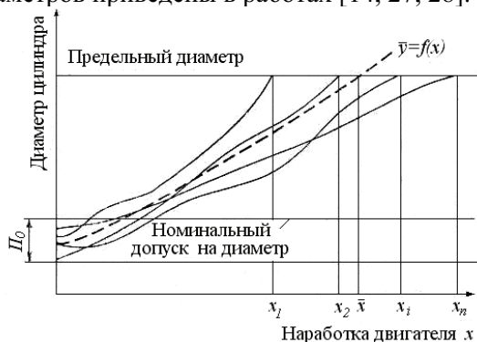
Рис. 3.19. Возможные изменения диаметра цилиндров двигателя по мере его работы
