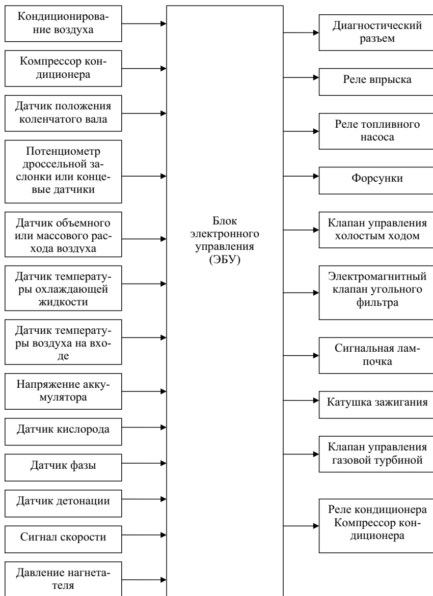
Рис. 1.41. Блок-схема типичной электронной системы управления бензиновым двигателем
