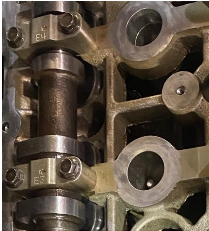
Рисунок 2 – Відновлені робочі поверхні розподільчих валів
