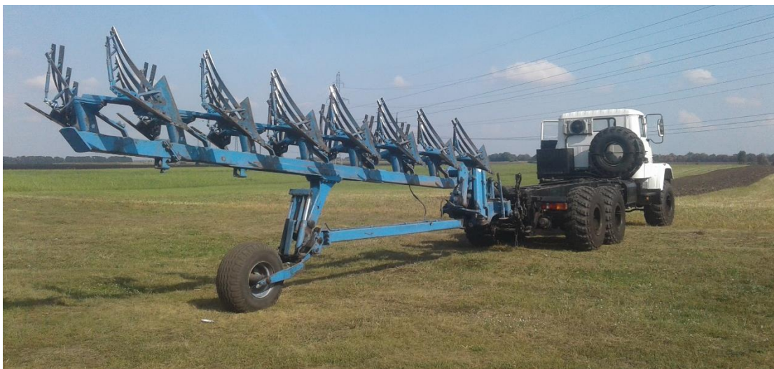
Рисунок 1 – Орний агрегат на базі мобільного енергетичного засобу МЕЗ-330 «Автотрактор» та плуга Rabe&Werk
