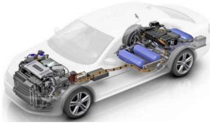
Рис.1. Конструкція електромобіля на водневому паливі
