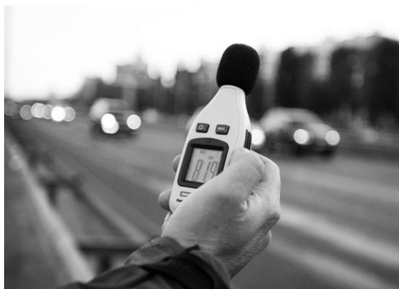
Рисунок 1.3 – Електронний шумомір SL-401
