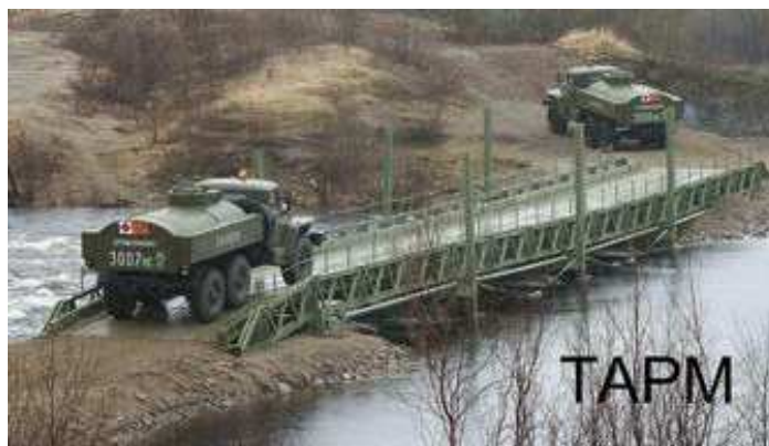
Рисунок 1 – Вид мосту із комплекту ТАРМ
