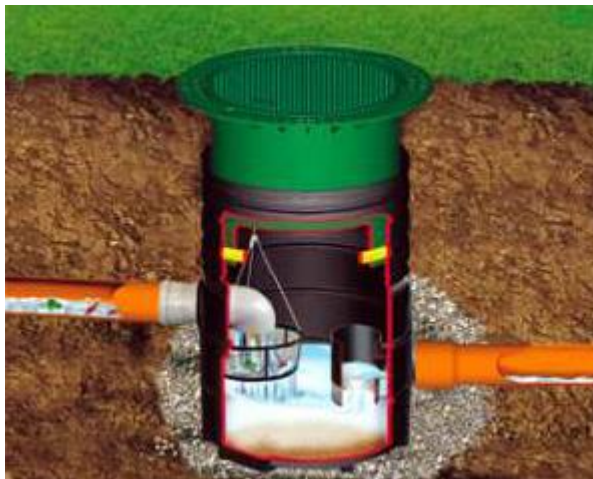
Рисунок 12.5 – Дренажний оглядовий з'єднувальний колодязь
