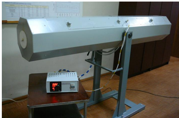
Рисунок 1 – Внешний вид калибратора температуры ТС-250
