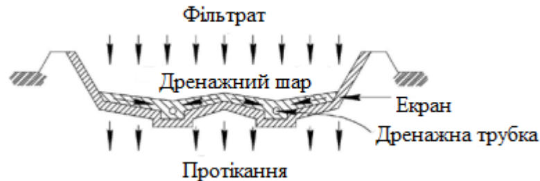
Рис. 1.1. Система протифільтраційного захисту майданчика складування шлакових відходів
