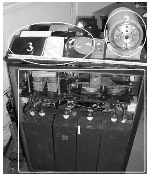
Рис. 1. Экспериментальный магнитно-импульсный комплекс: 1 – источник мощности (сильноточный генератор), 2 – индукторная система-инструмент, 3 – экспериментальные образцы.
