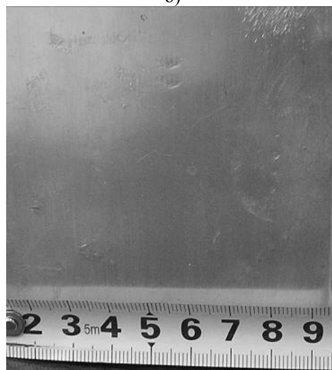
Рис. 4. Экспериментальные листовые образцы: а) сталь кузова автомобиля модели «Субару», толщина \sim 0,8 мм; б) сталь кузова автомобиля модели «Ситроен», толщина \sim 1,0 мм; в) нержавеющая сталь, толщина \sim 0,8 мм.
