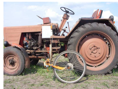
Рис. 3. Розміщення колеса шляховимірювального в комплекті з ДЧ В-01
