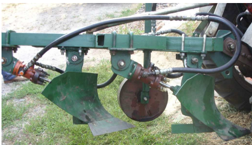
Рис. 2. Спеціально підготовлений експериментальний вібропуг ПЛН-2-25 із двома гідравлічними вібраторами
