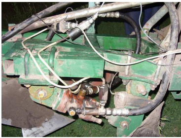
Рис. 5. Розміщення перетворювача тиску «ИПД 2»
