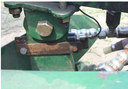
Рис. 6. Розміщення датчика вібрації Accelerometer Type 4369
