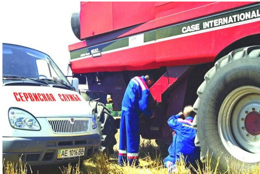
Рис. 1.3–Виконання сервісних робіт з Д, ТО і ПР машини пересувною майстернею
