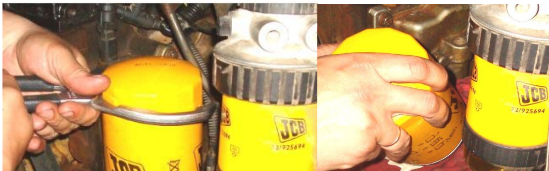
Рис. 5.3 – Операції по заміні масляного фільтра на навантажувачі JCB
