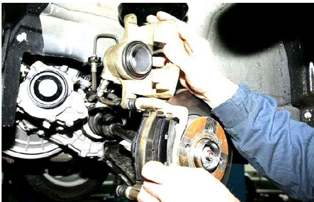
Рис. 8.2 – Перевірка стану деталей та вузлів гальмівної системи при ТО
