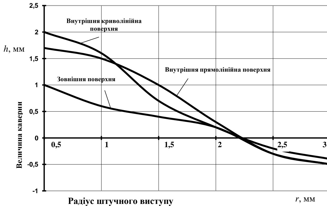
Рисунок 2 – Графіки залежності величини каверни на кромці деталі від радіусу штучного виступу в точці входу плазмового струменю в контур деталі з нульовою довжиною траєкторії входу (вхід у точці), побудовані за результатами експериментального дослідження
