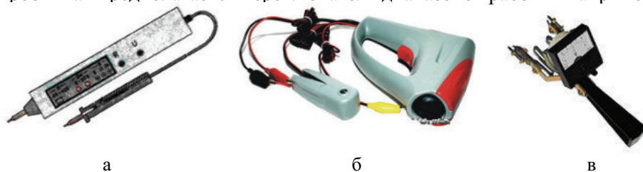
Рис. 4.21. Внешний вид переносных диагностических приборов: а – логический пробник (индикатор); б – стробоскоп; в – нагрузочная вилка
