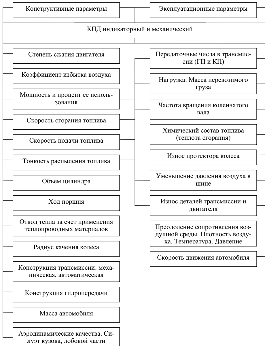
Рис. 3.28. Конструктивные и эксплуатационные параметры автомобиля, оказывающие влияние на расход топлива
