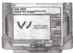
Рис. 4.24. Измерительный комплекс VAS 5051 и VAS 5052
