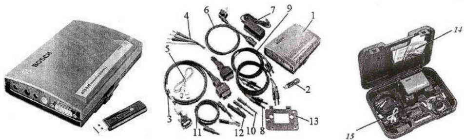
Рис. 4.27. Внешний вид тестера KTS 570 и его комплектующие:
