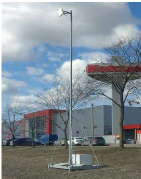
Рисунок 2 – Приклад виконання системи автоматичного дослідження параметрів транспортного потоку [ https://www.itc.by/its-solution/adaptive-control/arken/ ]
