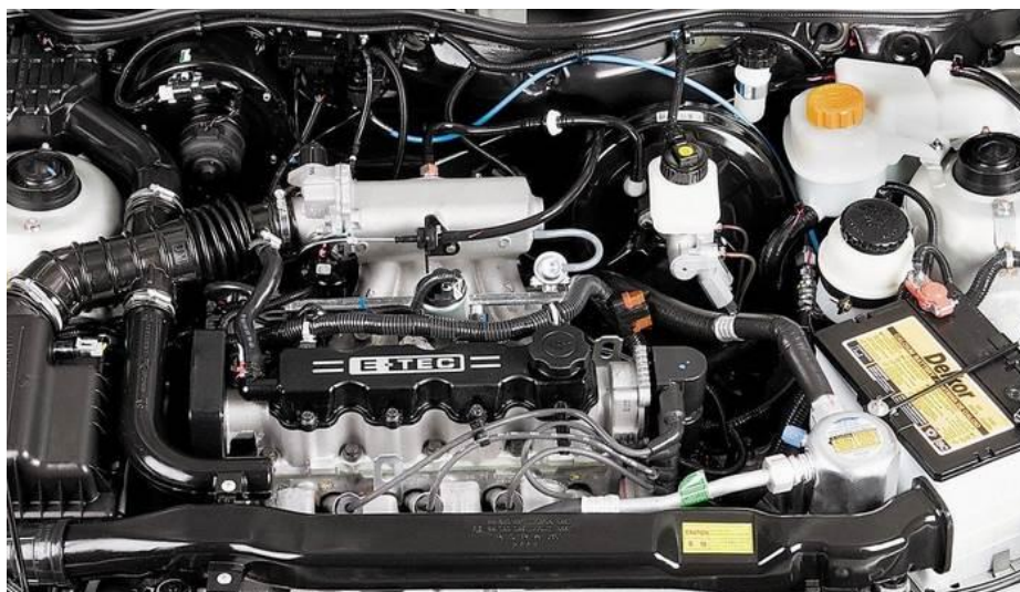
Рисунок 1.2 – Двигун Daewoo Nexia об'ємом 1,5 літра [1]
