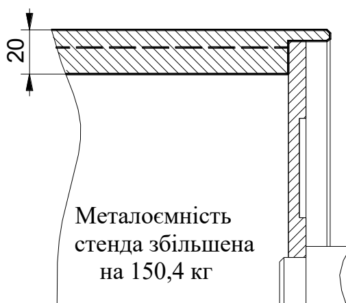
Рисунок 1 – Доробка конструкції нового стенду шляхом збільшення товщини стінки ролика
