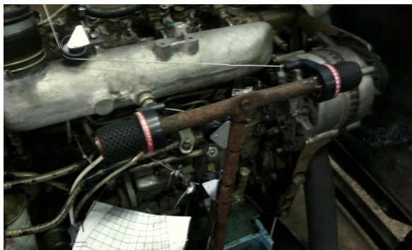
Рис. 5. Керування важелями паливоподачі в газодизельному режимі
