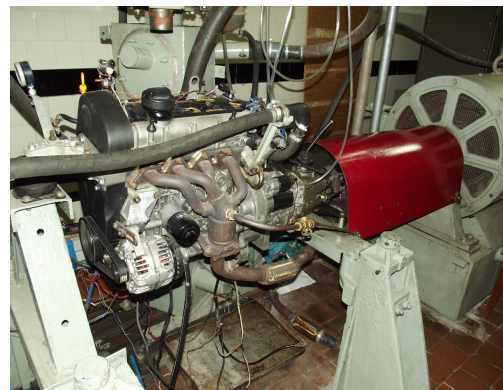
Рис. 1. Об'єкт експериментальних досліджень – двигун 4С 7,65/7,56 із сучасною системою впорскування бензину
