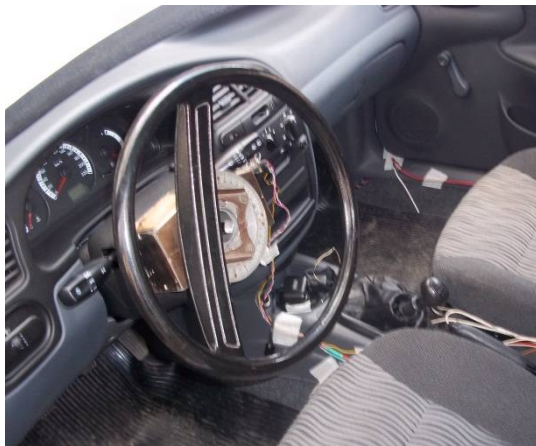
Рис. 5. Вимірювальне рульове колесо дослідного автомобіля
