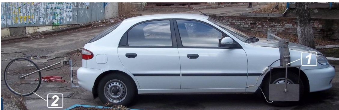
1 – датчик виміру кутів сходження коліс та їх повороту; 2 – «п'яте» колесо вимірювального комплексу
