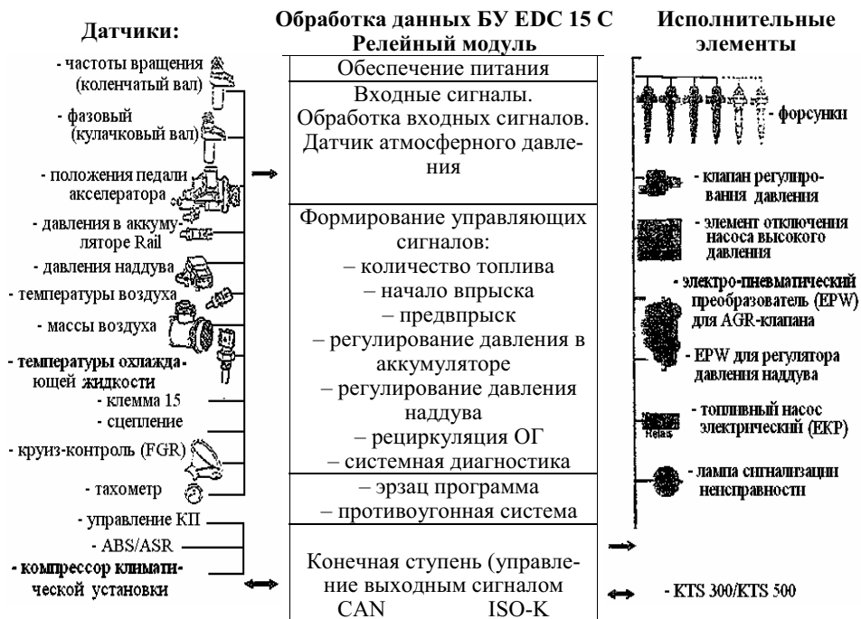
Рис. 4.32. Компоненты системы EDC дизельного двигателя
