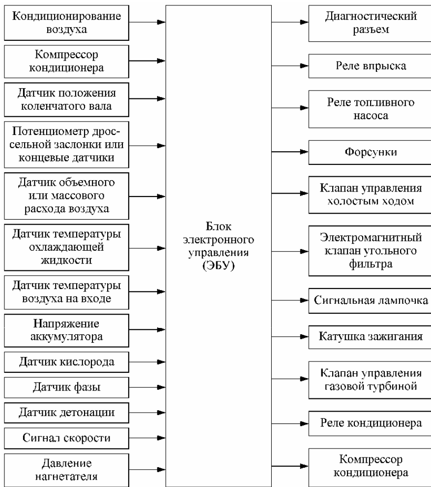
Рис. 3.57. Блок-схема типичной электронной системы управления бензиновым двигателем
