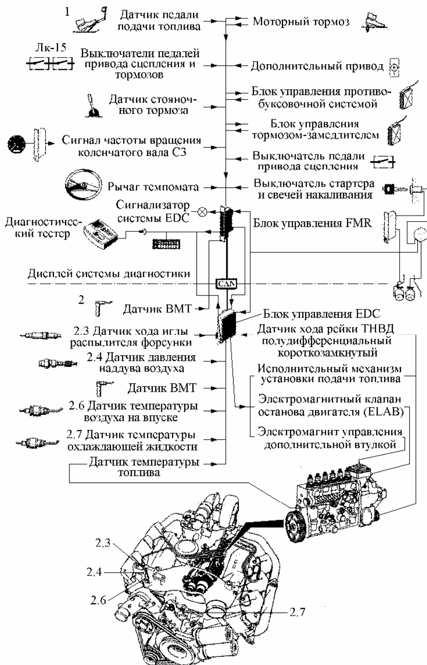
Рис. 1.11. Функциональная схема электронного управления дизельным двигателем, оснащенным рядным ТНВД с дополнительной втулкой:
