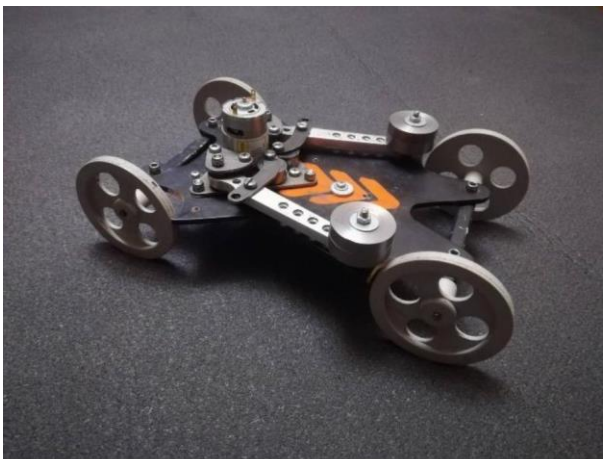
Рисунок 4.1 - Загальний вигляд масштабної моделі колісного малогабаритного транспортного засобу з інерційним рушієм під час випробувань
