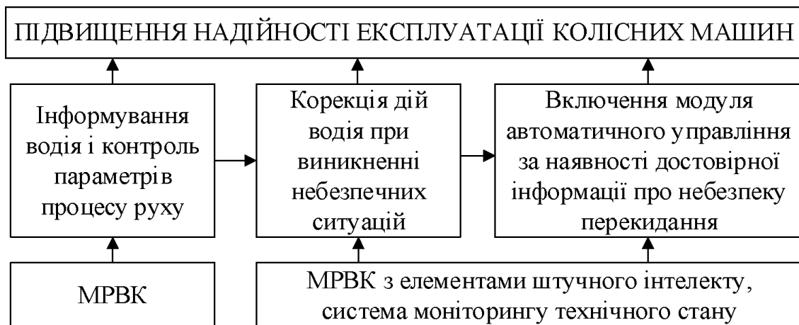
Рисунок 4.2 - Структурна схема забезпечення надійності експлуатації колісної машини
