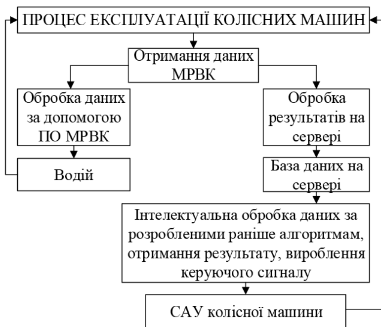
Рисунок 4.6 - Схема функціонування реєстраційно - імірювального комплексу з елементами штучного інтелекту
