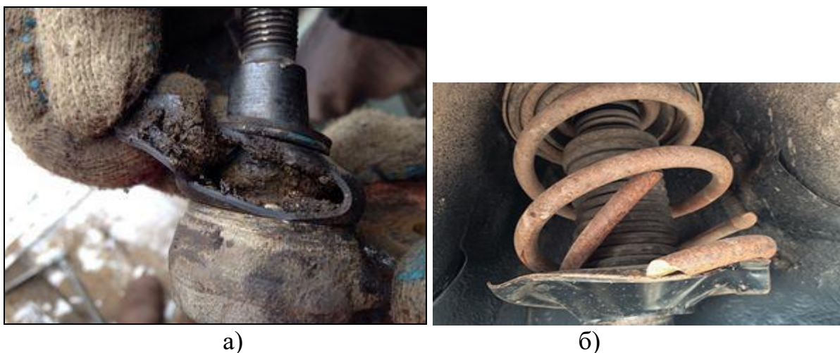
а) б) Рисунок 1 – Вигляд зношеої шарової опори та пошкодженої пружини підвіски
