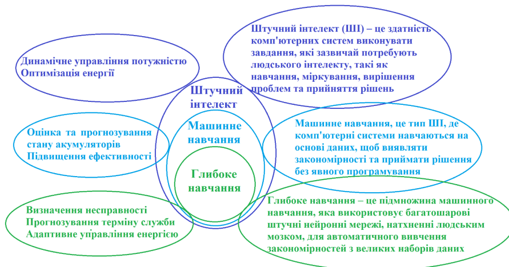
Рисунок 2 – Огляд методів штучного інтелекту, які розробляються спеціально для систем управління акумуляторами електромобілів
