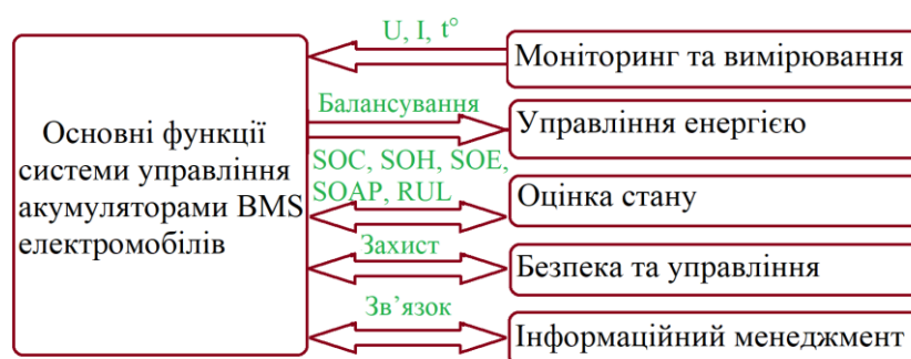
Рисунок 1 – Основні функції системи управління акумуляторами BMS електромобілів
