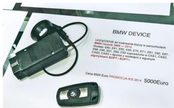
Рис.5. Комплект обладнання для відкриття автомобілів без оригінального ключа-брелка
