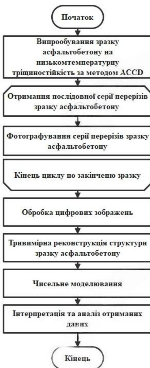
Рис. 1. Схема алгоритму комп'ютерного моделювання структури асфальтобетону
