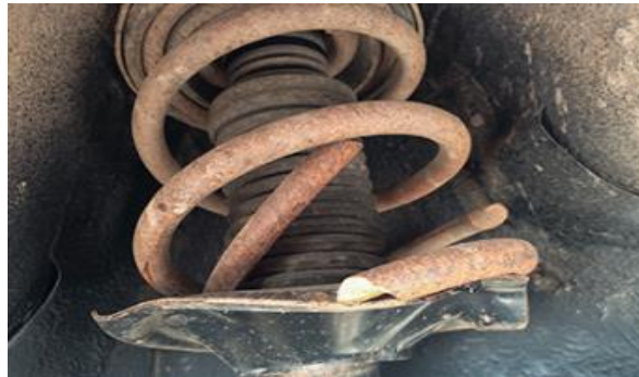
Рис.2-Лопнута пружина підвіски
