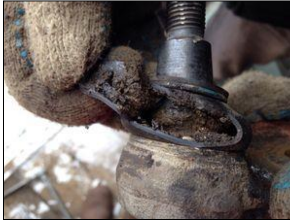
Рис.1-Розбита шарова опора Вигляд лопнутої пружини підвіски автомобіля:
