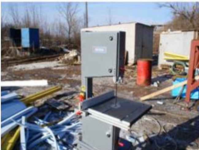
Рис. 1.14. Елементи самонесучого остова залізобетонних оболонок: а–г – елементи остова для фрагмента циліндра, сфери, нодіда та гіпару; д – верстат для розкрою листів пінополістиролу; е – процес установки вкладишів в остов
