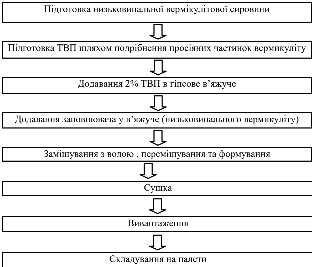
Рис. 4.2. Технологічна схема отримання ГВБ на ТВП.
