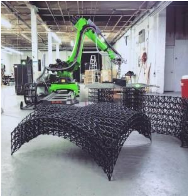
Рис. 1.4. Метод 3D printing C-Fab [19]: а – неметалевий арматурний каркас; б – фрагмент стіни
