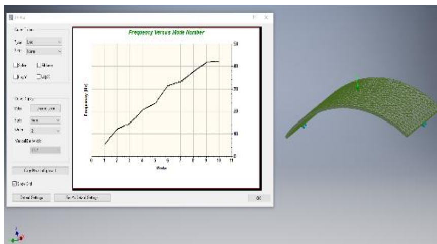
Рис. 2.13. Частоти власних коливань конструктивно-анізотропної оболонки розміром у плані 9000 × 3700 мм
