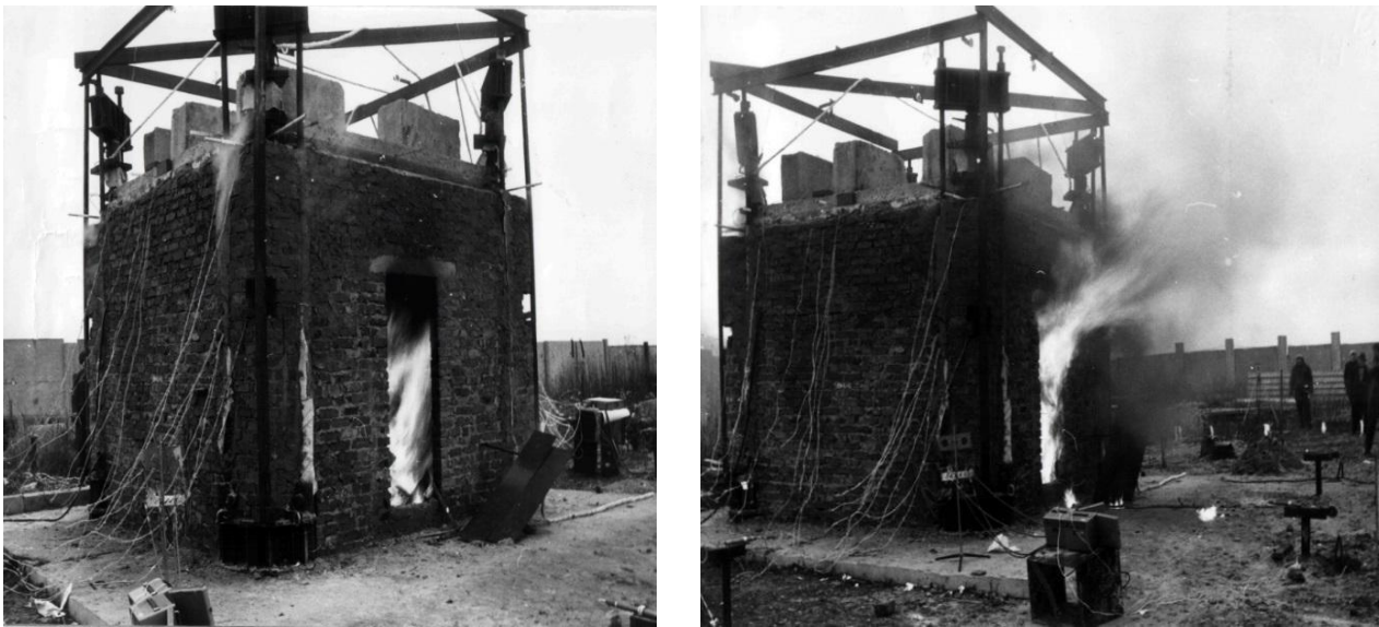
Рис. 2.29. Вогневий вплив на будівельну конструкцію (дослідження проф. В.С. Шмуклера) [73]
