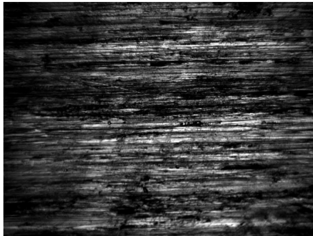
Рисунок 7.3 – Стан поверхні ролика 8 із сталі Nitrodur після випробувань на тертя протягом 120 (а), 150 (б) і 180 (в) хвилин
