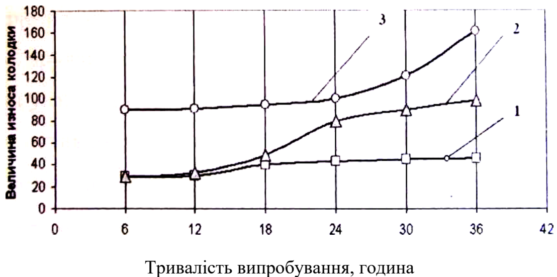
Рисунок 5.4 - Зміна величини відносного зношування в часі: 1 – сталь 25ХГСП, 2 – сталь А335/А335М, 3 – сталь 30Г
