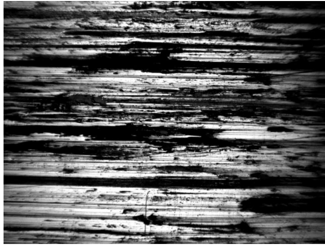
Малюнок 7.1 – Стан поверхні ролика 3 із сталі 25ХГСР після випробувань на тертя на протязі та 120 (а), 150(б) та 180(в) хвилин
