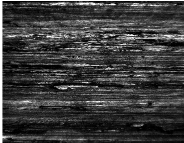
Малюнок 7.1 – Стан поверхні ролика 3 із сталі 25ХГСР після випробувань на тертя на протязі та 120 (а), 150(б) та 180(в) хвилин
