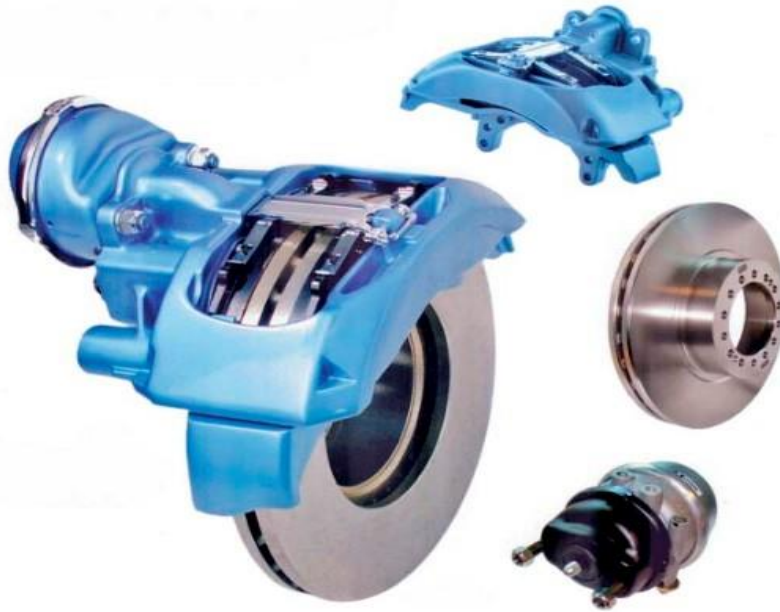
Рисунок 2 - Основні вузли дискового гальма вантажного автомобіля [2]
