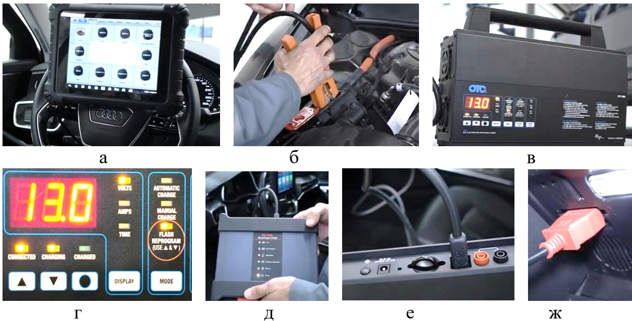
Рисунок 9.5 – Підготовка приладів до роботи: а – встановлення сканера; б – підключення джерела живлення; в, г – установка напруги живлення; д – підключення інтерфейсу зв'язку до сканера; е, ж – підключення інтерфейсу зв'язку до OBD II рознімання
