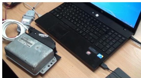
Рисунок 8.5 – Підключення приладів: а – адаптера до ПК; б – програматора до ЕБК
