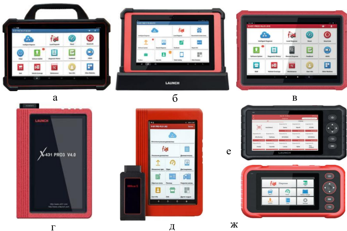
Рисунок 7.1 – Лінійка сканерів Launch X-431 Pro: а – PADVII; б – PADV; в – PRO5; г – PRO3 v 4.0; д – PRO (2017) з адаптером DBScar 5; е – CRP 349; ж – CRP 233/239
