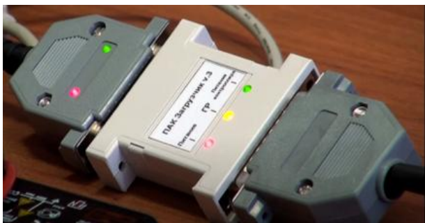
Рисунок 8.5 – Підключення приладів: а – адаптера до ПК; б – програматора до ЕБК
