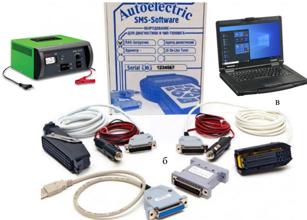
Рисунок 8.1 – Засоби репрограміngu ЕБК: а – джерело живлення; б – комплектація приладу «Загужчик v.3»; в – ноутбук
