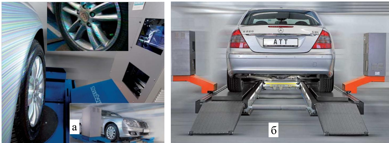
Рисунок 3.7 – Стенд аналізу геометрії ходової частини CURA R 2000 АТТ: а – растрове підсвічування автомобіля проектором; б – вигляд стенду
