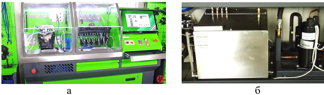
Рисунок 4.4 – Склад контрольно-вимірювального комплексу DiMeD EXPERT: а – робочі панелі комплексу; б – відсік з тестовою рідиною
