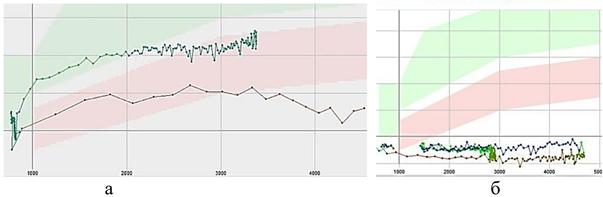
Рисунок 12.5 – Вікна вкладки «Випередження»: а – вихід за межі дозованих коридорів; б – непрацездатність автоматів випередження
