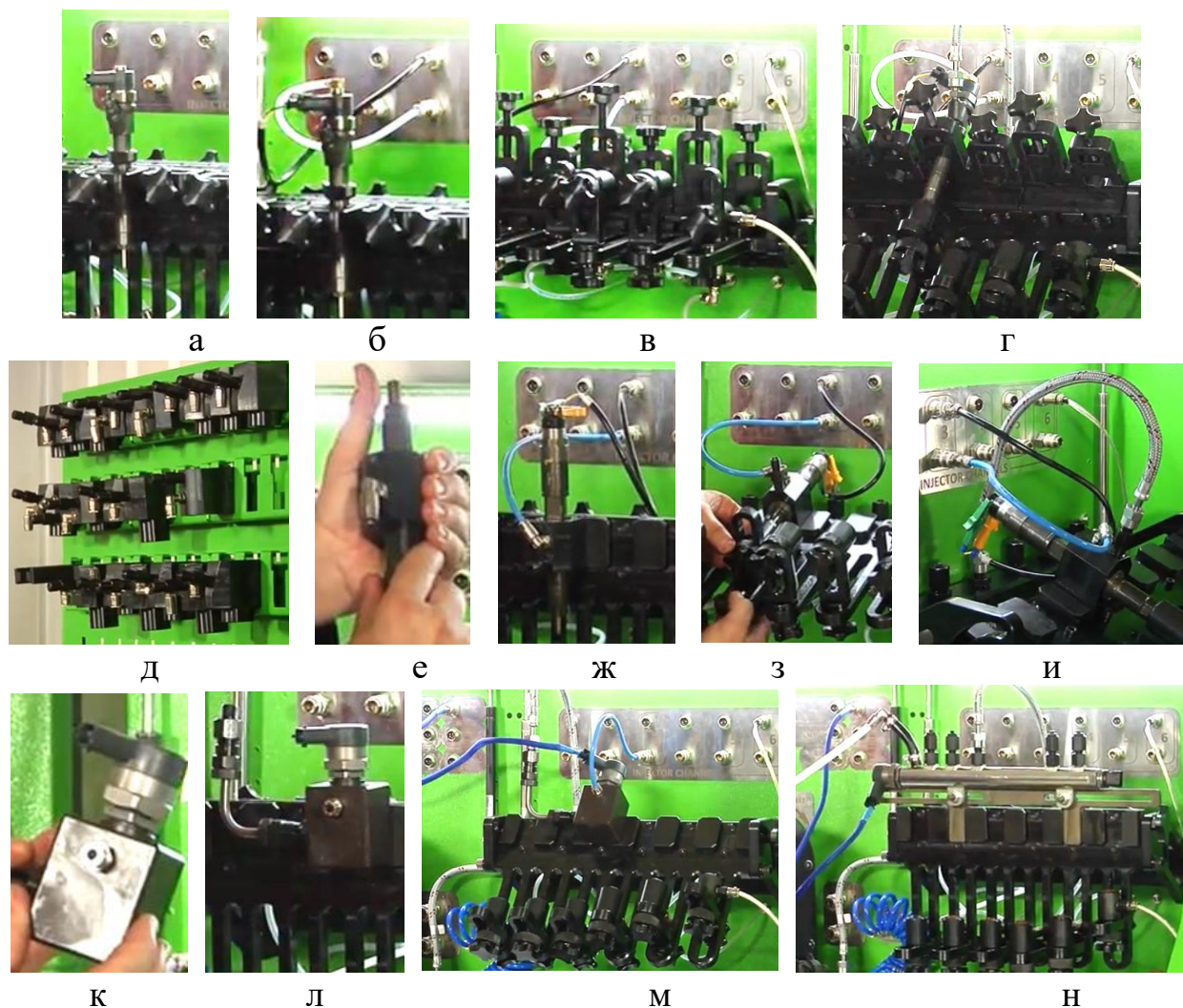
Рисунок 5.5 – Установка компонентів систем CR на стэнд:
