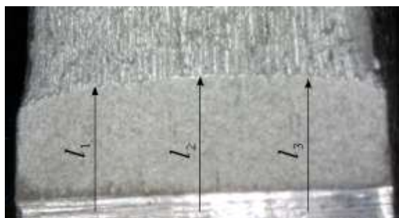
Рис. 3. Контур вихідної утомлюваної тріщини
