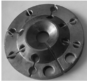
Рис. 6. Одновитковый индуктор с внутренним отверстием конического профиля
