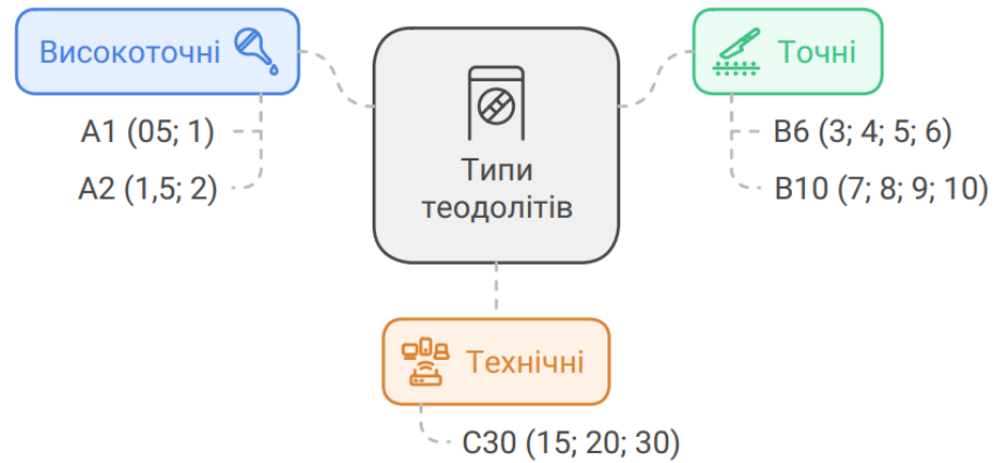
Рисунок 2 – Класифікація теодолітів за точністю [1]
