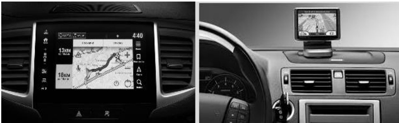
Рисунок 1 – Інтегрований та стаціонарний автонавігатори відповідно
