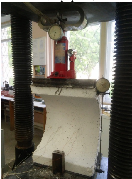
Рисунок 1 – Загальний вигляд дослідження водовідвідного лотка
