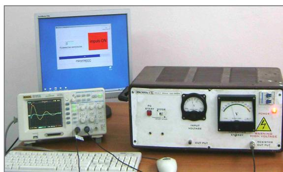
Рис. 3. Внешний вид комплекса для имитации и моделирования процессов в инструментах магнитно-импульсной обработки металлов
