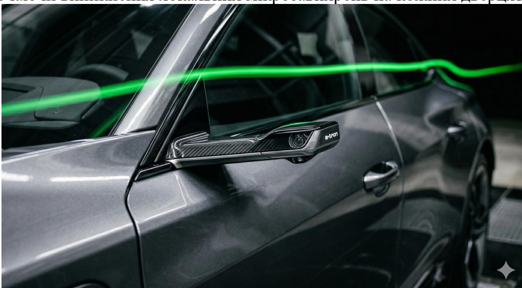
Рисунок 8 - Віртуальні дзеркала-камери (Virtual Mirrors)
