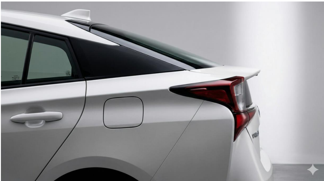
Рисунок 6 - Хвіст Камма (Kammback) на прикладі Toyota Prius
