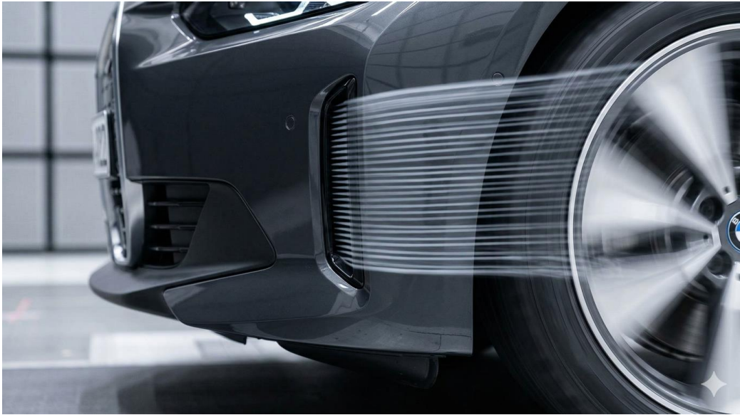
Рисунок 7 - Повітряні штори (Air Curtains) на передньому бампері
