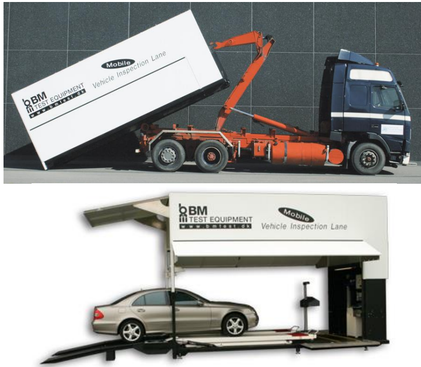
Рисунок 6 – Мобільна інспекційна станція VM80000 (Данія)
