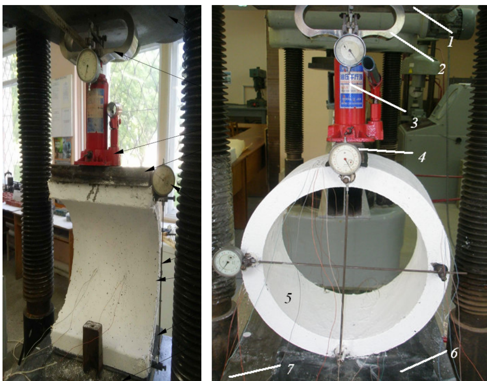
Рисунок 1 – Загальний вигляд випробування безнапірної труби та лотка притрасового водовідводу
