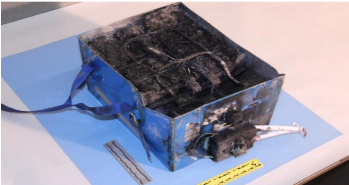
Рисунок 7.2 – Загоряння блоків акумуляторі на борту Боїнга 787
