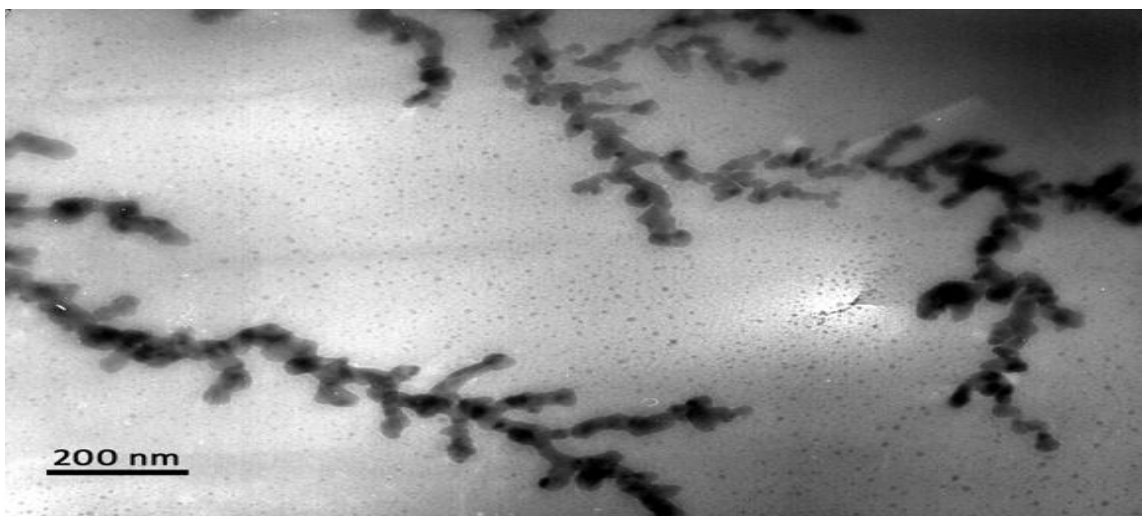
Рисунок 4.3 – “Проростання” ланцюжків металевого літію (дендритів)
