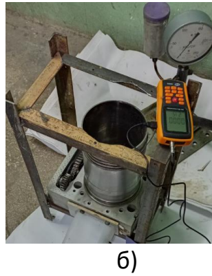
Рисунок 1 – Загальний вигляд термоанемометра (а) та елементів безмоторного стенду (б)
