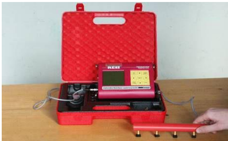
Рисунок 3 – Прилад „Resi” для вимірювання ймовірності корозії арматури
