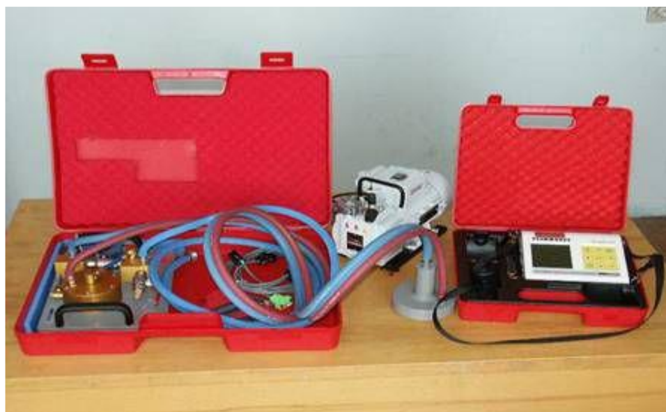
Рисунок 2 – Система „Torrent” для вимірювання водонепроникності бетону
