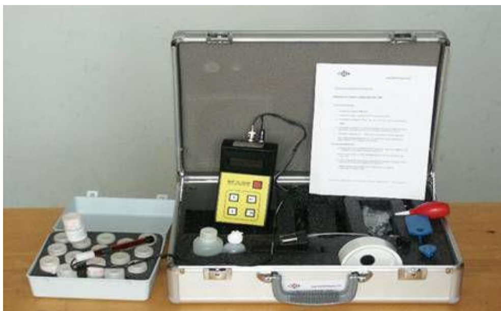
Рисунок 1 – Обладнання „CL 2000” для визначення вмісту хлоридів
