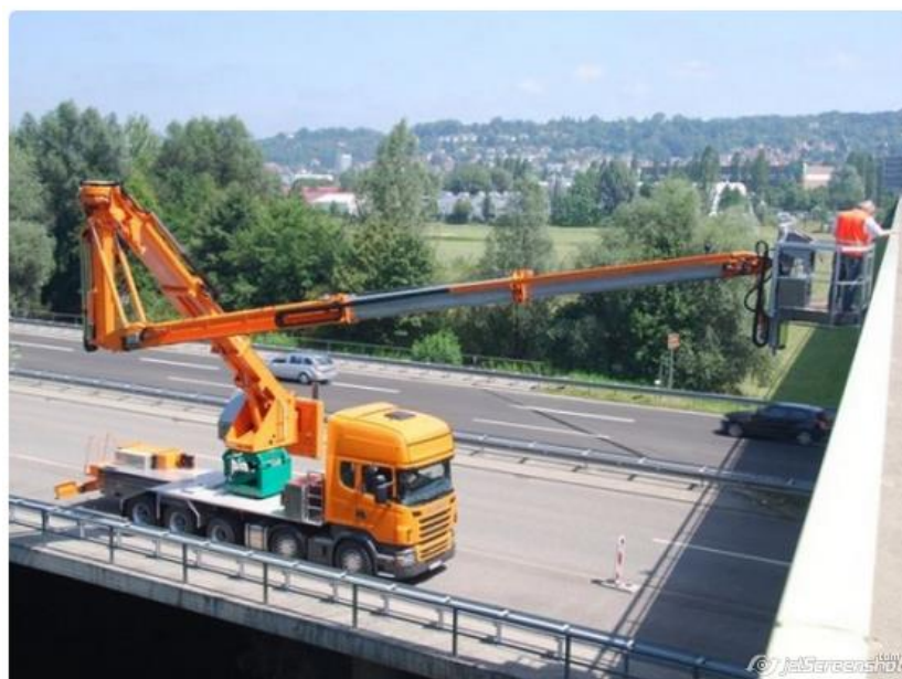
Рисунок 7 – Машина MBL-1750 T (Германія) для обстеження мостів,
