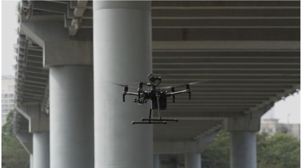
Рисунок 8 – Використання квадрокоптерів з камерами для виявлення дефектів
