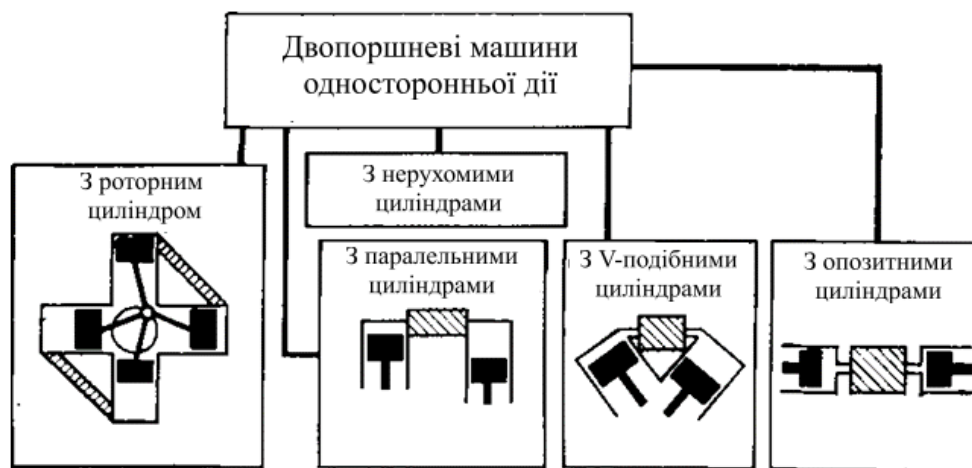
Рис. 2 – Можливі варіанти компоувальних схем двопоршневих машин односторонньої дії
