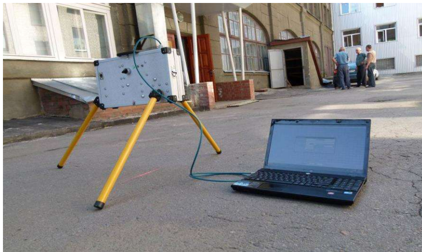
Рисунок 1 – Прилад для визначення шорсткості ПЛПШ-1
