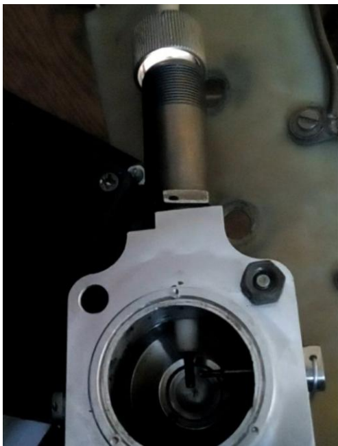
Рисунок 4 – Діагностичне устаткування для пошуку місця іскрового розряду котушки запалювання системи АФП в умовах лабораторії ДП «Харківське конструкторське бюро з двигунобудування»
