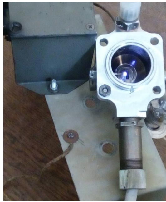
Рисунок 5 – Наявність зразкового іскрового розряду між центральним електродом свічки запалювання і бічним електродом підігрівача системи АФП при справності усіх складальних компонентів
