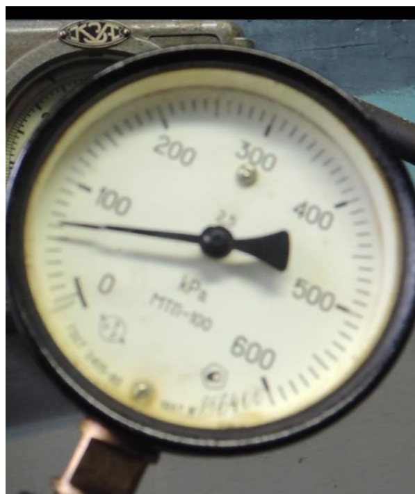
Рисунок 3 – Показання манометру діагностичного устаткування у процесі вимірювання тиску повітря у порожнині «в» при пошуку несправності у роботі підігрівача системи АФП
