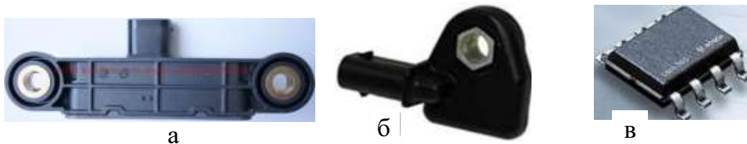
Рис. 1.20. Інтегральні комбіновані датчики автомобільних систем: а – датчик кутового прискорення; б – модуль SMI540; в – мікросхема SD787
