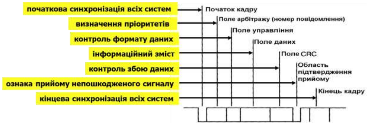
Рис. 1.3. Формат кадру по шині CAN
