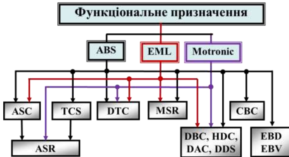
Рис. 1.8. Функціональна структура систем стабілізації курсу
