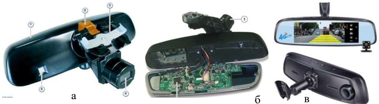
Рис. 2.7. Компонування елементів відіосистем: а, б – з камерою у внутрішньому дзеркалі заднього виду; в – з автономною камерою
