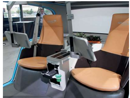
Рис. 2.15. Безпілотний автобус-човник Rinspeed Snap: а – зовнішній вигляд; б – облаштування пасажирського салону
