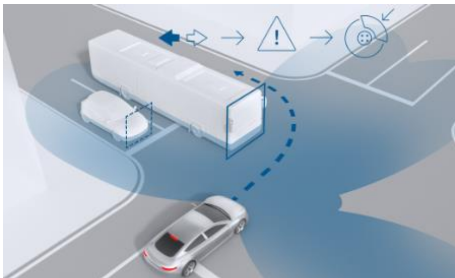
Рисунок 2. Принцип роботи системи екстреного гальмування при переїзді перехрестя
